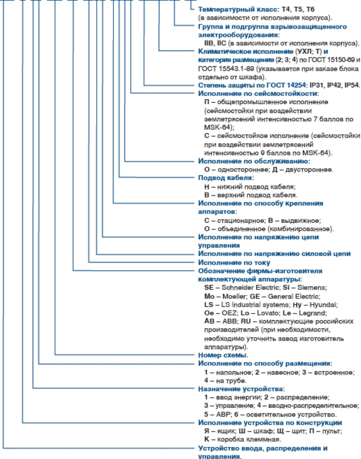
» Структурная схема обозначения блока
