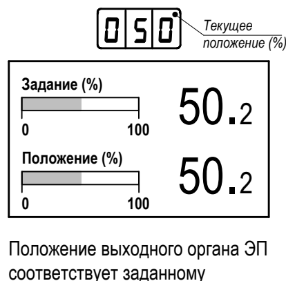
Рисунок 5 – Графический вид дисплея и цифровой индикатор. Информация о положении и задании положения
