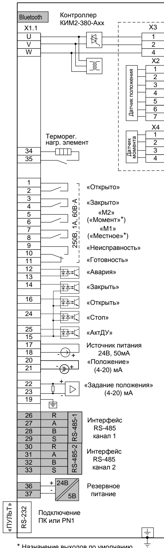
Рисунок Ж.3.2 – Схема контроллера КИМ2-380 конфигурации А конструктивного исполнения "14"
