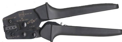
Рисунок Н.1 –Инструмент монтажный для обжима контактов 09990000021
