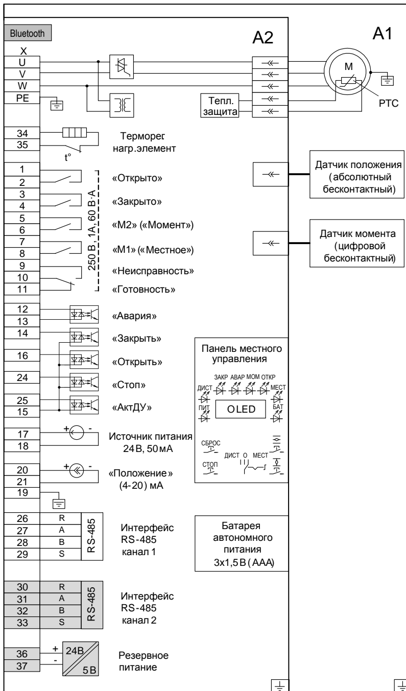
Рисунок Д.5 – Схема привода трехфазного исполнения ПЭМ-Е2Тхх или ПЭП-Е2Тхх с дополнительными опциями
