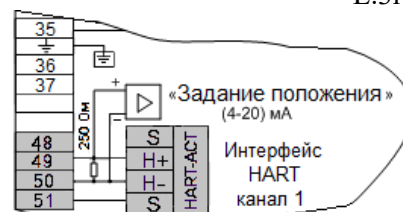
Рисунок Е.3 – Схема механизма МЭО(Φ)-Е3Ахх с дополнительными опциями
